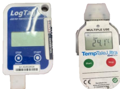
FIGURA 1 Monitores electrónicos de temperatura (datalogger)
