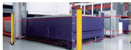
Estos dispositivos se han diseñado para la protección de las personas que operan o trabajan en la cercanía de las máquinas y permiten, al mismo tiempo, un libre acceso a ellas, deteniendo los movimientos peligrosos de las partes en el momento en el que se corten los haces de luz.
