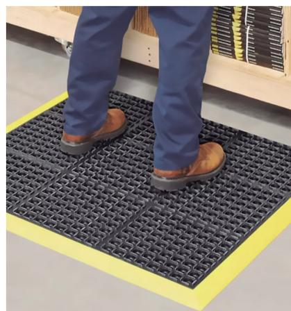
Se han diseñado principalmente para garantizar la seguridad del personal y servir de complemento a los productos de seguridad, como los dispositivos de seguridad sensitivos, y permitir así el acceso libre para la carga y descarga de las máquinas. Funcionan detectando a las personas cuando entran en contacto con la alfombra o tapete y provocan la parada del movimiento peligroso.
