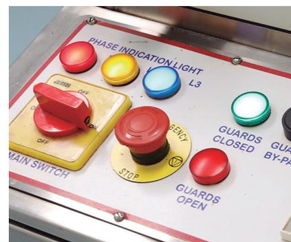
La función esencial del dispositivo de paro de emergencia será interrumpir (en caso de peligro) el suministro de las fuentes de alimentación de energía (corriente eléctrica, aire a presión, entre otros) y parar la máquina lo más rápidamente posible.
