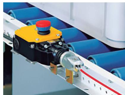
Los interruptores de paro de emergencia por tracción de cable se ponen en estado operativo mediante el tensado previo del cable. De esta manera, los contactos NC se cierran y los contactos NA se abren. Al existir tensión o rotura de cable, los contactos NC se abren y se cierran los contactos NA. A continuación, el interruptor de paro de emergencia por tracción de cable se puede volver a poner en estado operativo mediante el rearme manual.
